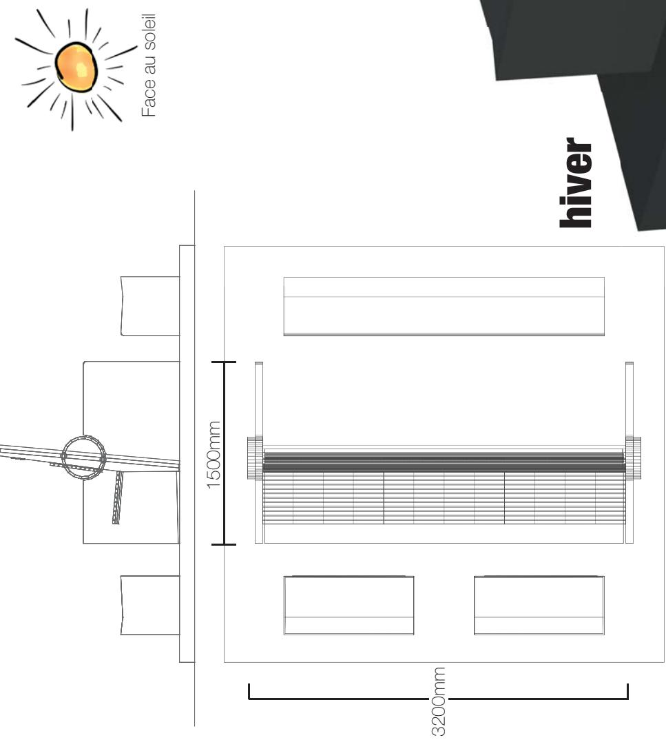
Tables d'appoint - système chauffant à l'intérieur - en fonction seulement lorsque l'espace est utilisé. L'inclinaison du dossier permet de profiter des rayons du soleil du Sud tout en se protégeant des grands vents du Nord. L'inclinaison permet d'admirer les vieux vestiges industriels le long du canal.
